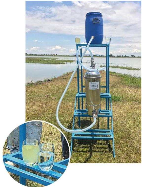
Das Modul besteht aus einem Filtrationsgefäß mit integrierten Ultrafiltrationsmembranen. Zur Trinkwasserproduktion muss es lediglich mit einem höher gelegenen Rohwassertank verbunden werden. Das Rohwasser fließt mittels Schwerkraft in das Modul und wird durch die Membrankartusche im Filtrationsgefäß gereinigt. Pro Modul können pro Tag bis zu 8000 l Trinkwasser gewonnen werden.
